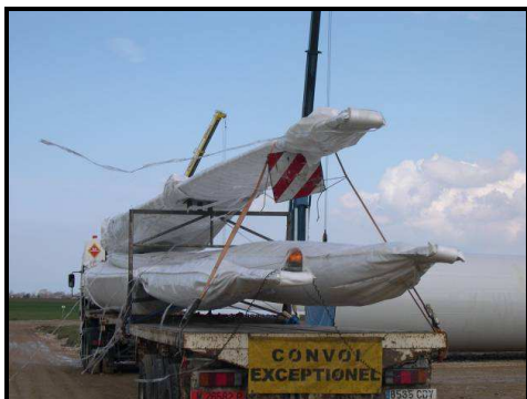
Chantier du Petit Terroir : arrivée des pales en convoi exceptionnel
